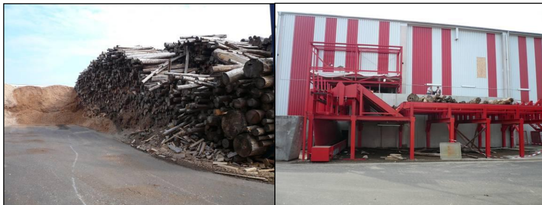
Ábra 22: Pelletgyári alapanyagok: fűrészpor és hengeres fa (bal oldal) valamint pelletgyári rönksztal hengeres fa fogadásához (jobb oldal)
